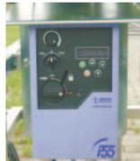
rechts: Drehzahlsteuerung des E-Motors
