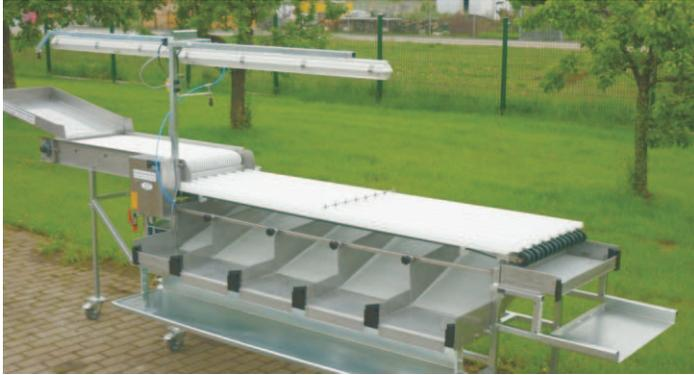
**Mit aufgebautem Vorsortierband zum manuellen Aussortieren von fehlerhaften oder angefaulten Früchten**
